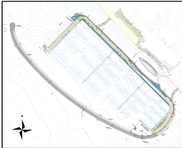
I posti barca sono stati orientati secondo le direzioni dei venti più frequenti e dominanti.
